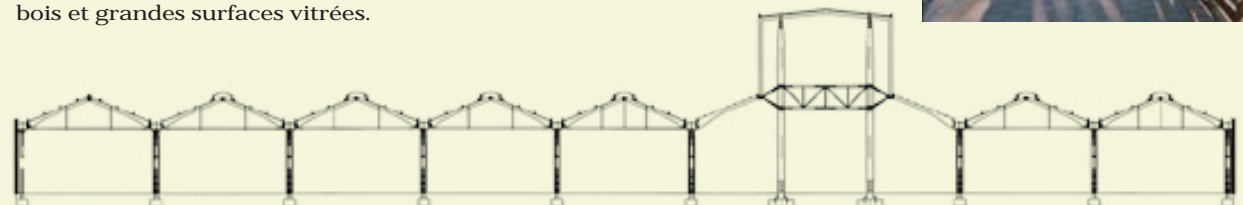
▲ Coupe transversale sur la structure du bâtiment, composée de toits à deux pans juxtaposés encadrant le double volume de la serre.
